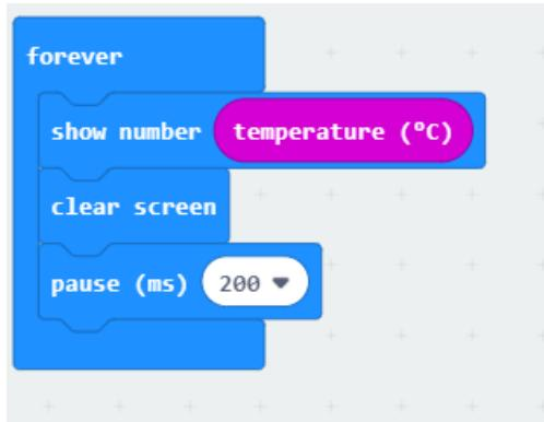
Slika 29: Naredbe programa za mjerjenje temperatur u Makecodu – blokovi
