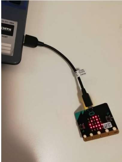
Slika 20: Spajanje micro:bita s usb kablom
