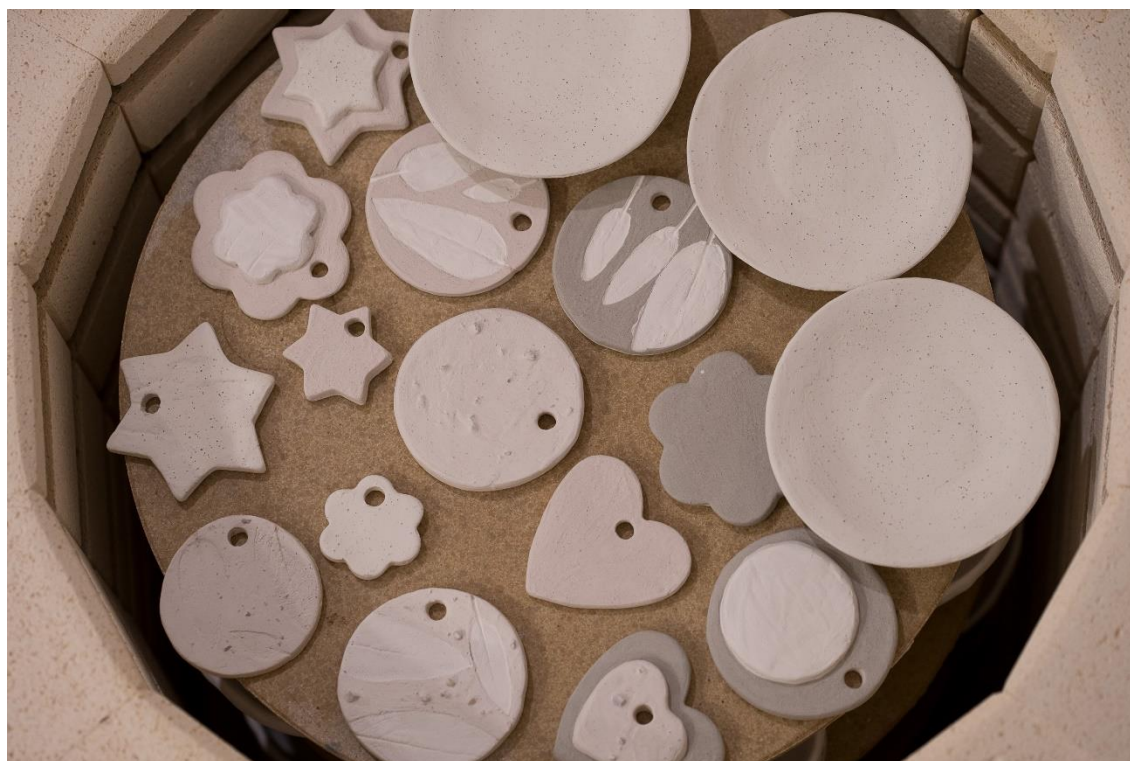
Slika 12. Predmeti posloženi u keramičkoj peći – glazurno paljenje
