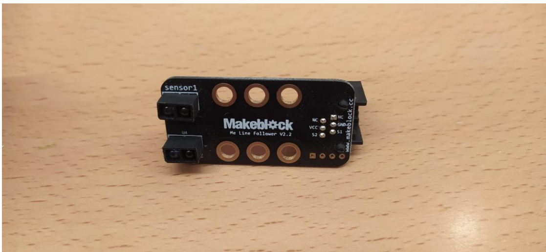
Slika 17. Fotografija prednje strane senzora za praćenje linija (Samostalna izrada)
