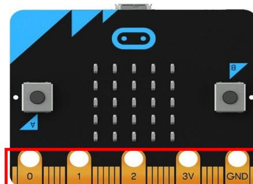
Slika 39. Ulagno-izlazni kontaktni izvodi
