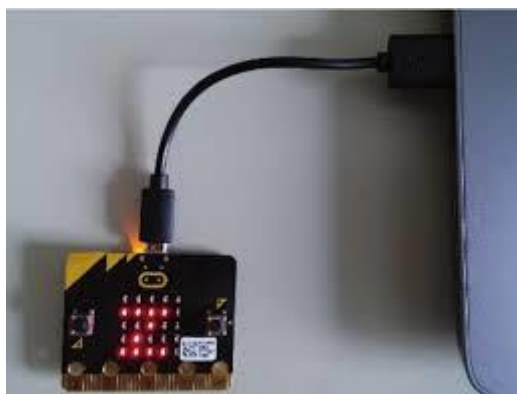
Slika 42. Povezivanje BBC micro:bit uređaja USB kablom (Preuzeto dana 26.4.2020. https://www.profil-klett.hr/datoteke/razno/Python_na_microbit_u_2017_100%20dpi%20.pdf )
