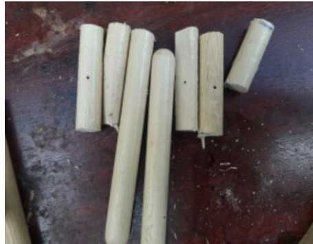
Slika 7. rupice za spajanje torza
