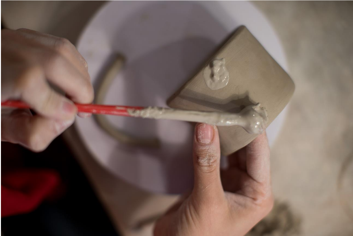
Slika 5. Prikaz nanošenja tekuće gline prilikom spajanja dijelova gline
