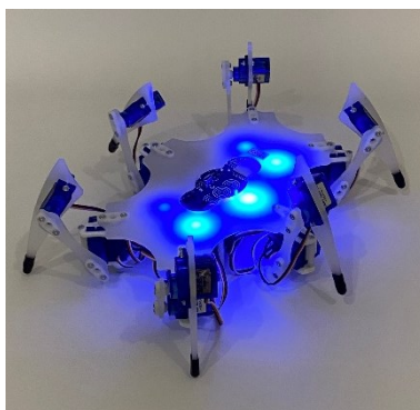
Slika 7. STEMI Hexapod robot
