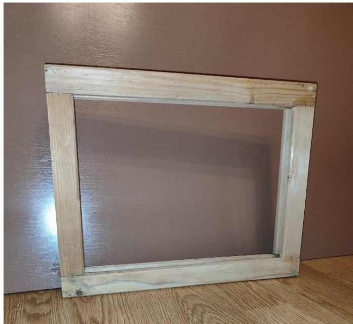
Slika 11. Izrada okvira za butaj
