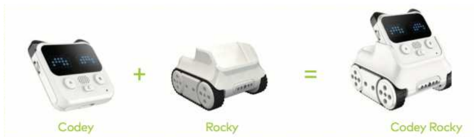
Slika 12. Prikaz dijelova Codey Rockyja (Makeblock, 2023)
